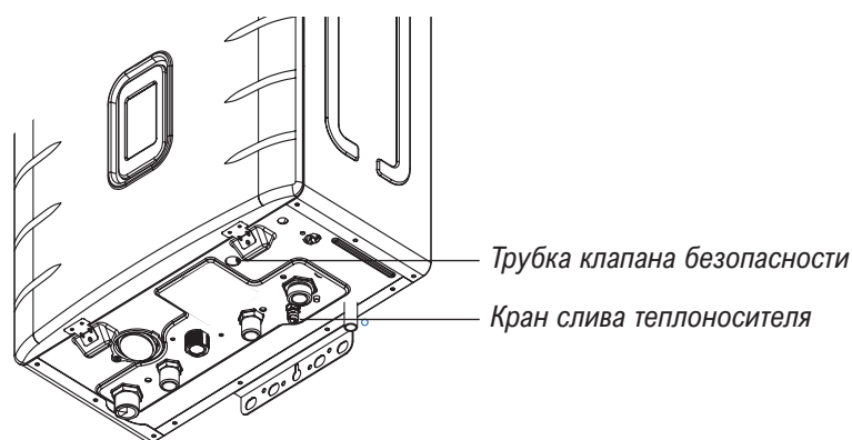
Рисунок 4. Схема нижней панели котла.
