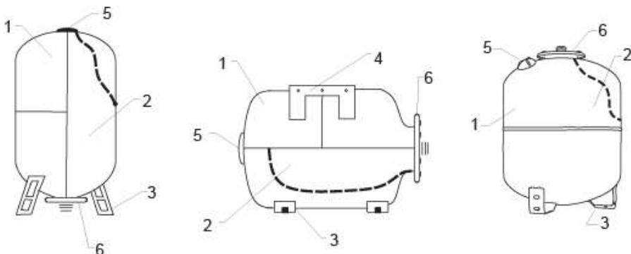
под давлением некоторый запас воды. При использовании совместно с реле давления, позволяет создать автоматическую станцию на базе погружного или поверхностного насоса. Гидроаккумулятор состоит из стальной емкости (бака) – (1), внутри которой находится резиновая мембрана (2). Внутренняя полость мембранны соединена с напорной магистралью через фланец (6), а в полость между
