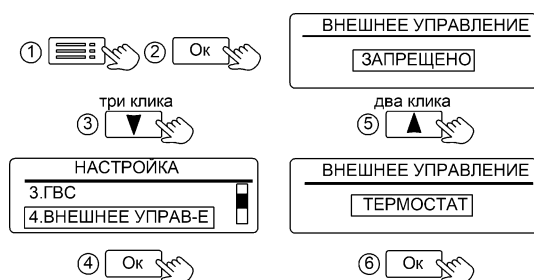
Рисунок 19. Настройка работы от внешнего устройства
