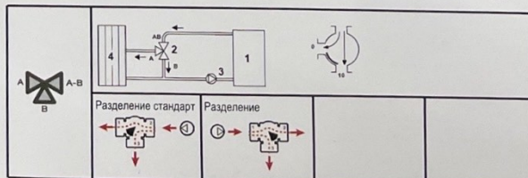
Схема настройки трехходового клапана в качестве распределительной арматуры
