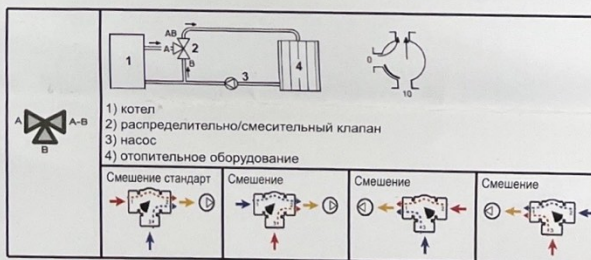
Схема настройки трехходового клапана в качестве распределительной арматуры
