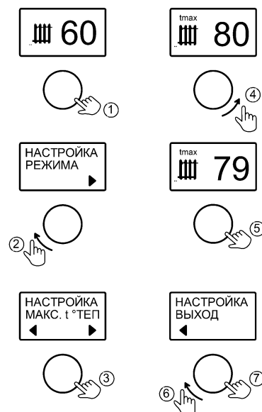
Рисунок 9. Настройка максимальной температуры теплоносителя
