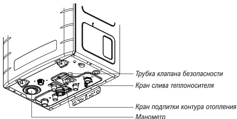
Рисунок 3. Схема нижней панели котла.
